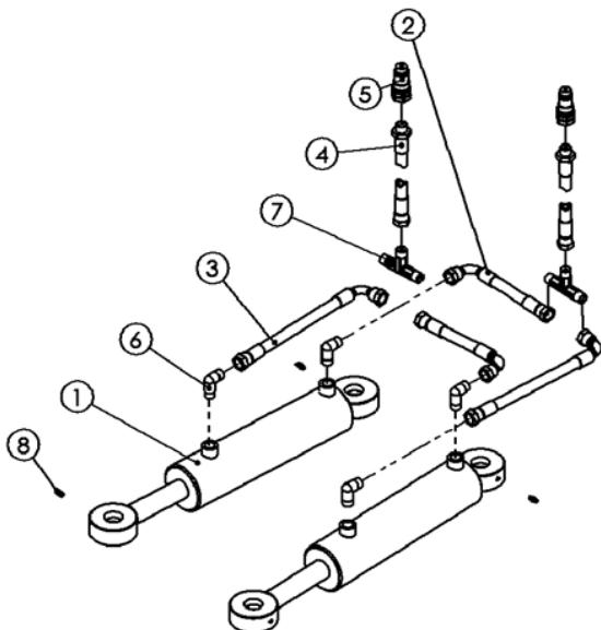
*Slika 5: Osnovni deli hidravličnega sistema*
