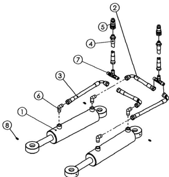
**Slika 5:** Osnovni deli hidravličnega sistema
