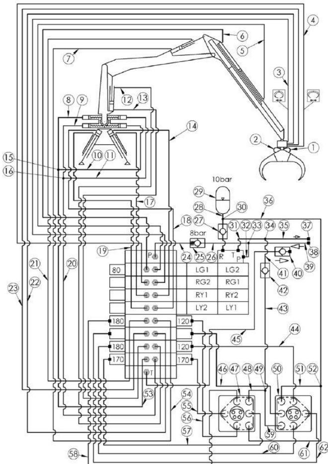
**Slika 4** Hidraulični diagram On/Off krmilnega ventila
