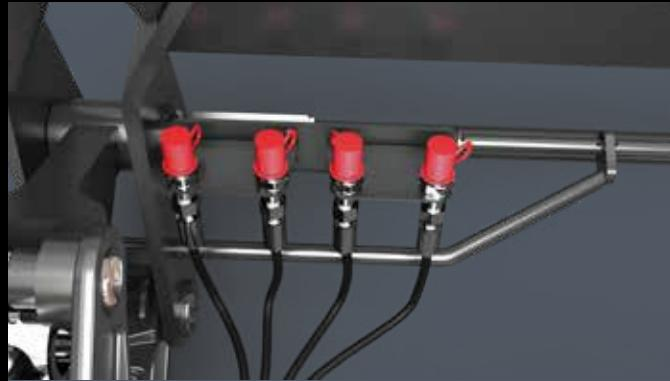
**3. IN 4. HIDRAVLIČNI KROG.** (tukaj kot vtična spojka)
